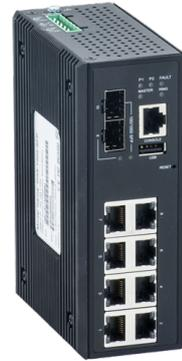
La série contient des switches robustes de haute qualité pour l'implémentation d'une structure en réseau boucle redondante Ethernet 10, 1000 et 1000Mbits selon IEE802.x, les ports en cuivre ont Power over Ethernet (PoE+). Ces switches ont été développés pour l'usage industriel. La construction d'un ou plusieurs boucles fibres optiques se fait par la connexion du switch.
