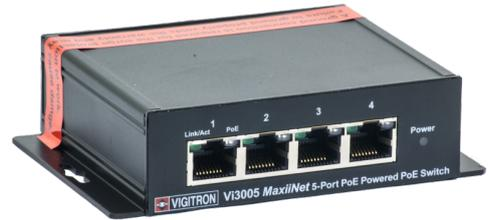
Le switch VI-3005 alimente quatre ports Ethernet 10/100BaseTX avec un uplink par UTP- ou par câble de fibre optique. En plus de la possibilité d'alimenter directement les consommateurs avec PoE, le switch lui même peut être alimenter par un port uplink avec PoE. Grâce au "plug-and-play" il ne faut pas de configuration de la software. Grâce à sa forme compacte le switch VI-3005 est très polyvalent dans son emploi.
